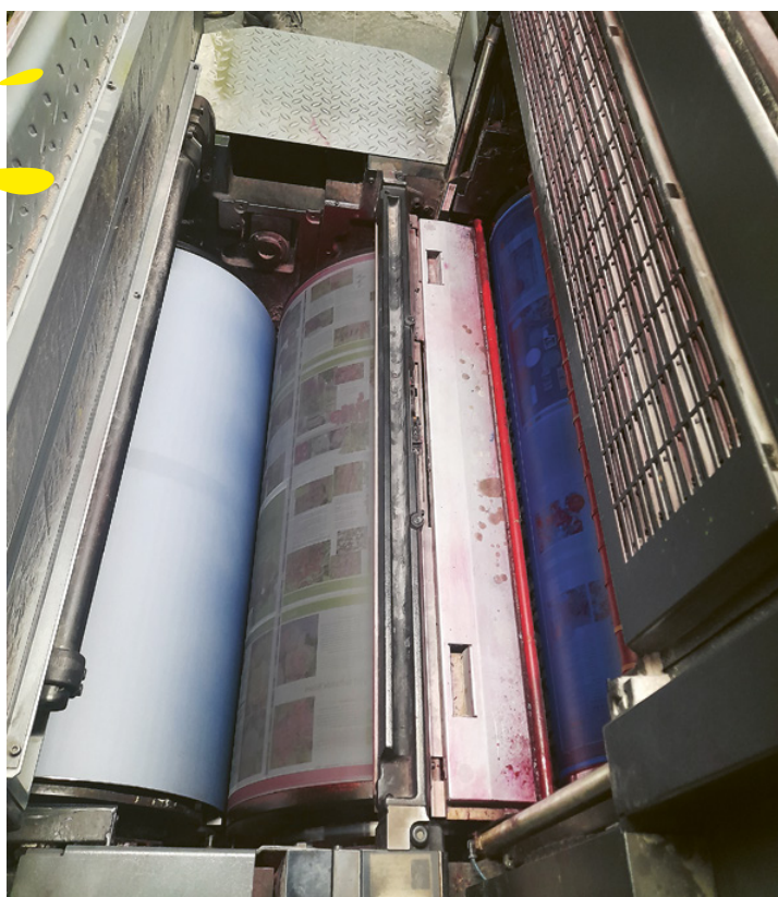
Mit der Druckplatte (rechts) wird die Farbe auf das Papier (links) übertragen.
