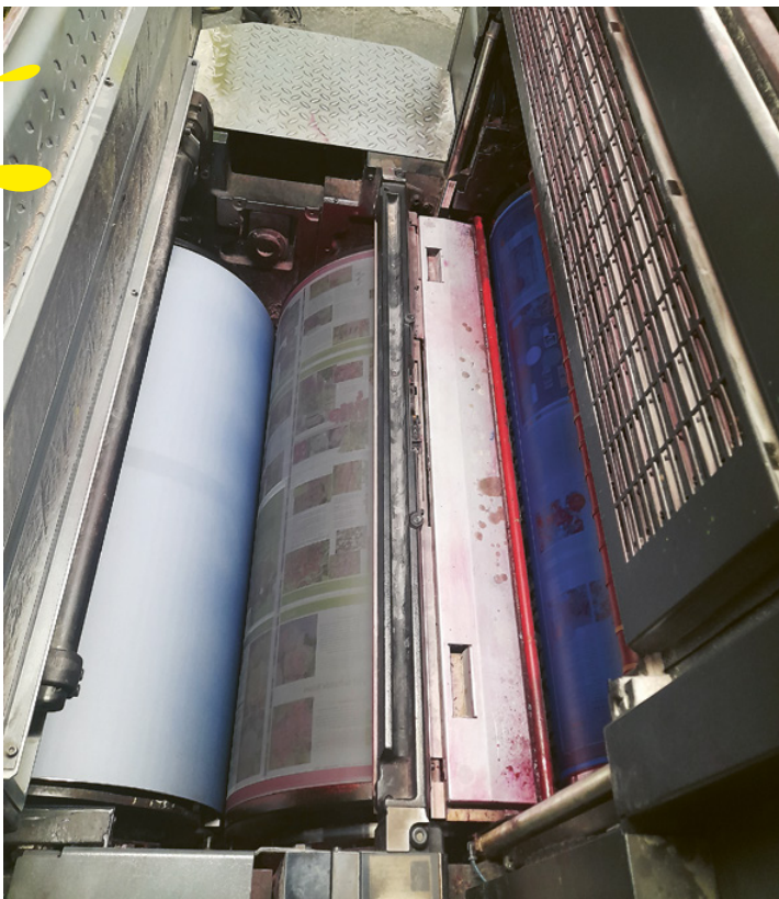
L'encre est transférée sur le papier (à gauche) à l'aide du cliché (à droite).
