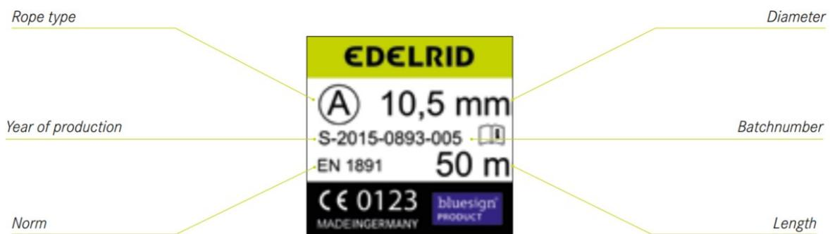
Abbildung 1: Beispiel einer Kennzeichnung bei einem Statikseil
