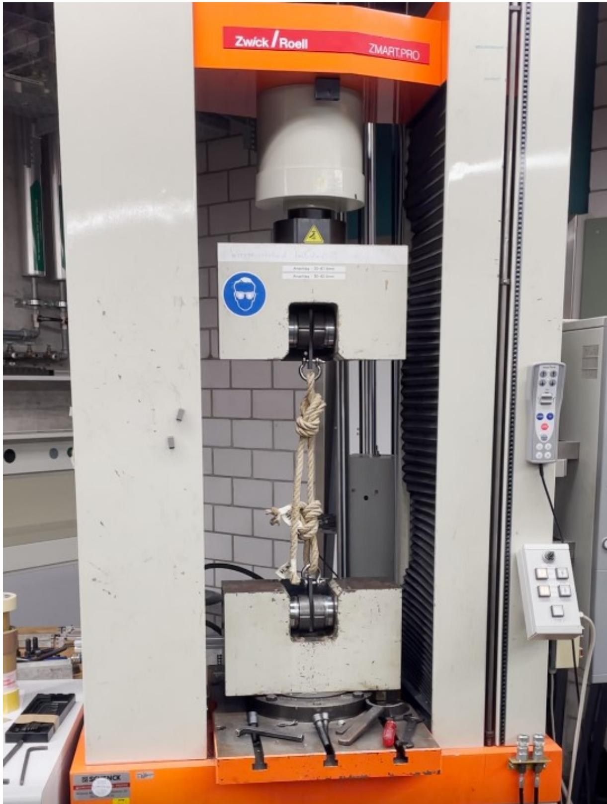
Abbildung 22: Verwendete Zugmaschine
