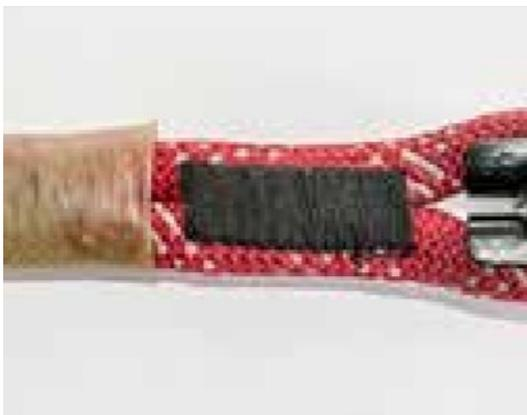
Die Nähte und Knoten müssen überprüft werden. Dafür kann gegebenenfalls die Schutzabdeckung abgezogen werden, um die darunter befindlichen Sicherheitsnähte ordnungsgemäß überprüfen zu können. Ist eine der Nähte durchgeschnitten, gerissen oder abgenutzt, muss das Seil aus dem Verkehr gezogen werden.
