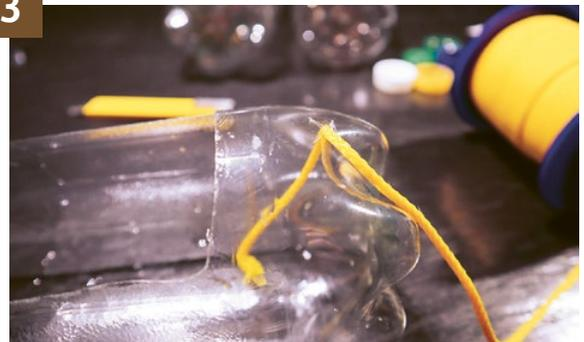
**Löcher für die Aufhängevorrichtung:** Du brauchst eine stabile Schnur, die gut hält. Die Flaschen werden nämlich ziemlich schwer mit Erde und Wasser drin! Schneide mit dem Cutter neben dem Feld oben und den Löchern unten je zwei kleine Kreuze. Diese dienen dann als Öffnungen, um die Schnur hindurchzuziehen und so sind die Löcher nicht viel grösser als die Schnur.
